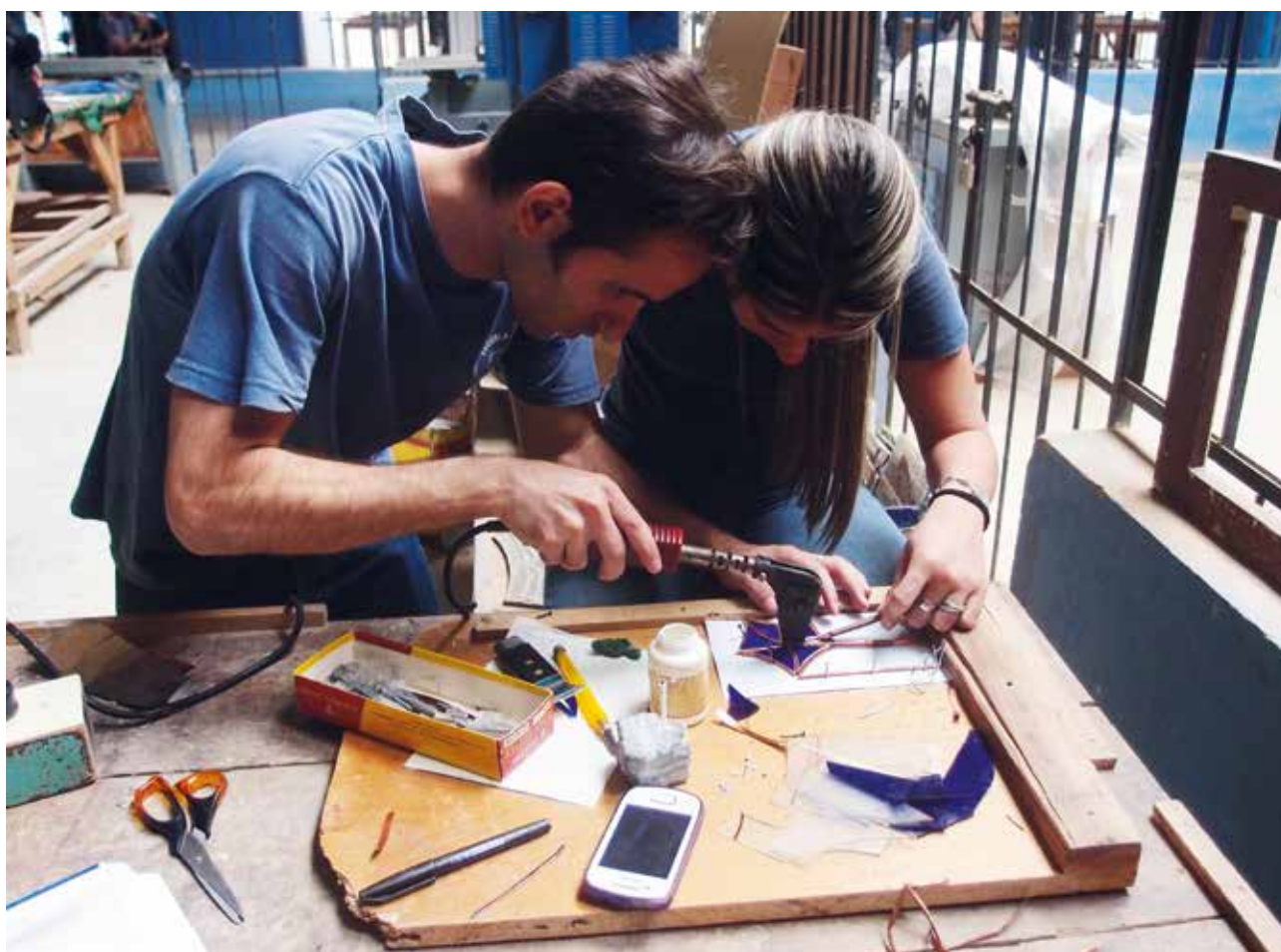
Noggrannt lödningsarbete för glasmosaikerna i de för Havanna typiska "mediopuntos" - de halvcirkelformade glasfönstren. Foto Achmed Radwan
