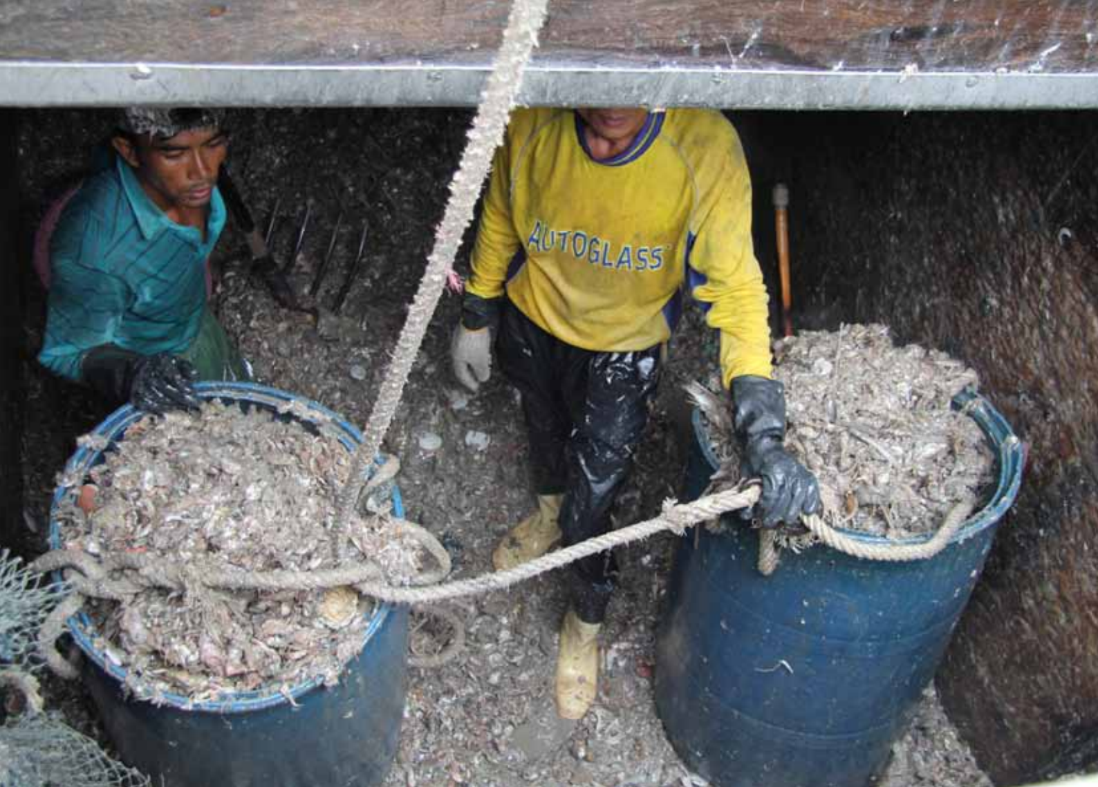
Arbetare nere i trålarens lastutrymme. De fyller dunkarna med skräpfisk som sedan lastas om till en lastbil. Arbetarna saknar skyddsutrustning och det finns ingen fläkt som leder bort metangasen som bildas i utrymmet.
